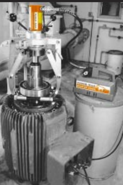
Le modèle SGH153CR, avec un accessoire d'extraction de roulement, utilisé pour la dépose d'un roulement de moteur de pompe.
