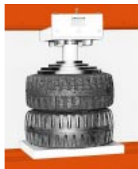
Introduction d'une jante dans un pneu plein au moyen d'une presse Power Team.
