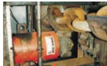
Die 1.370 m lange Ankerkette einer Ölbohrplattform wird mit 300-Tonnen Zylindern der Serie RD3006 vor Ort repariert.
