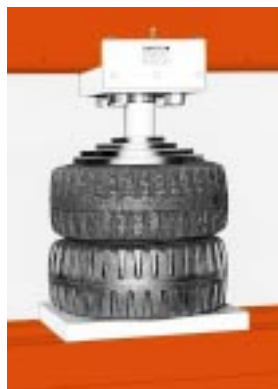
Einpressen einer Felge in neue Reifen mit einer Power Team Presse.
