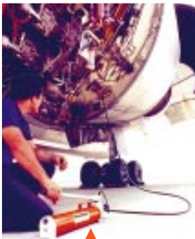
Die Handpumpe der Serie P157 beschleunigt das Öffnen der Schubumkehrer an Motoren der DC-10.
