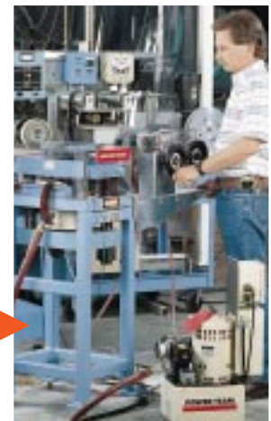
Die Heizungsisolierung wird mit Hochspannung und Power Team Hydraulikwerkzeugen geprüft.
