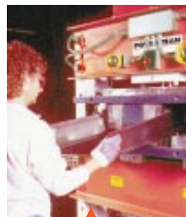
Aktenschränke werden kostengünstig mit 100-Tonnen Pressen hergestellt.
