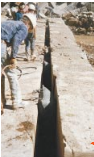
In einem Steinbruch erhöhen Luftkissen die Sicherheit und reduzieren den Ausschuß.
