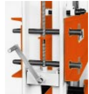
Hubspindel und Haltebolzen erleichtern Anheben des Pressenbettes.
